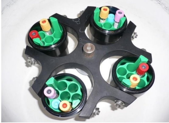
Şekil 13. Santrifüje tüpler kapakları kapalı şekilde karşılıklı dengeli olarak yerleştirilmez.
