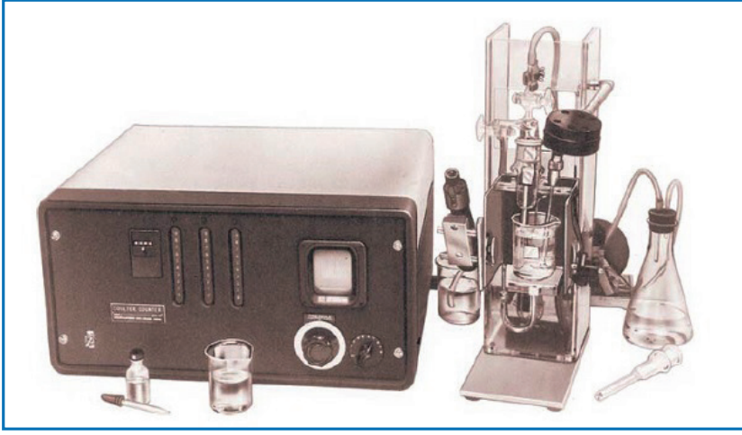
Şekil 11. Coulter kardeşlerce geliştirilen ilk otomatik kan sayım cihazının bir örneği (9)
